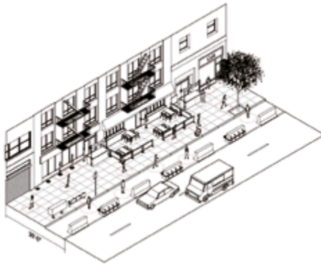
2. Σε πρώτο στάδιο, η μία λωρίδα του δρόμου αποδίδεται στην κυκλοφορία των πεζών με προσωρινές κατασκευές
